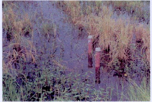
ภาพที่ 12 ท่อ piezometer ฝังอยู่ในนาข้าว เพื่อศึกษาคุณภาพน้ำใต้ดิน
