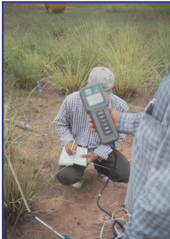
ภาพภาคผนวกที่ 1 ภาพเครื่องมือวัดค่าการนำไฟฟ้าในสนาม
