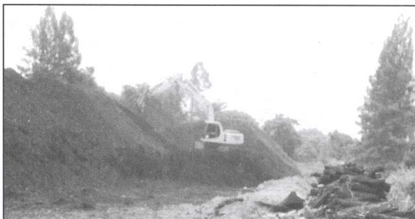
ภาพแสดงการกลับกองปุ๋ยหมักโดยใช้รถแทรกเตอร์หรือรถแมคโค
