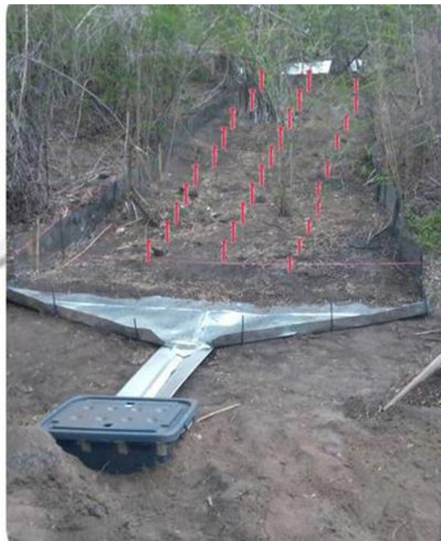
ภาพที่ 4 วิธีการปักหมุดในแปลงศึกษาการชะล้างพังทลายของดิน
