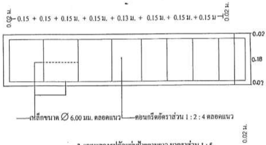
3. แบบแสดงรูปตัดแผ่นป้ายตามยาว มาตรฐาน 1 : 5
