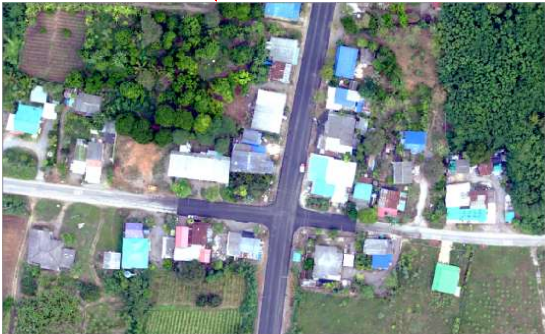
รูปที่ ๖๔ แสดงข้อมูลออร์โธรีจริง (True Orthophoto)
