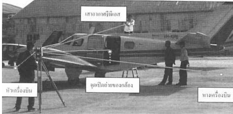
รูปที่ ๒๐ แสดงวิธีการใช้กล้องสถานีรวมหาค่าจีพีเอสออฟเซต (กระทรวงเกษตรฯ, ๒๕๕๖)
