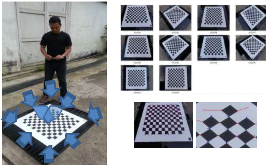
รูปที่ ๓๒ แสดงวิธีการวิเคราะห์หาความผิดเพี้ยนเลนส์ (lenses distortion modeling)
