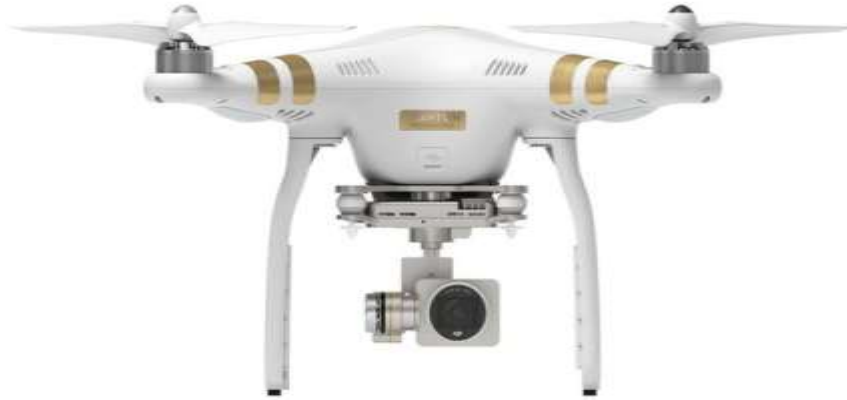
รูปที่ ๓ แสดงอากาศยานประเภทปีกหมุน รุ่น DJI Phantom ๓ professional (Da-Jiang Innovations, ๒๐๑๕)
