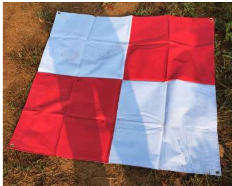
รูปที่ ๑๐ แสดงจุดควบคุมภาพถ่ายแบบเป่าชนิดให้สัญญาณ (signalized photo control point)
