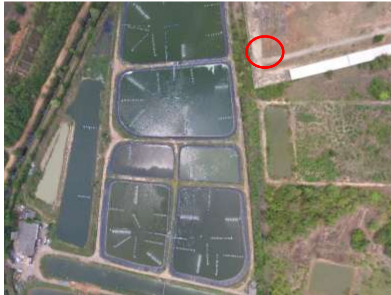
รูปที่ ๙ แสดงจุดควบคุมภาพถ่ายแบบธรรมชาติ (natural photo control point)
