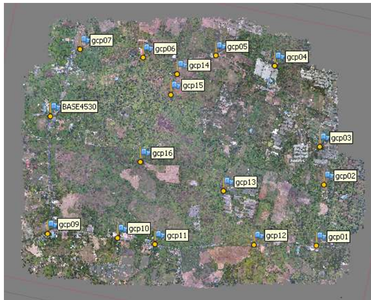
รูปที่ ๕๘ แสดงที่ตั้งของหมุดควบคุมภาพของโครงการ
