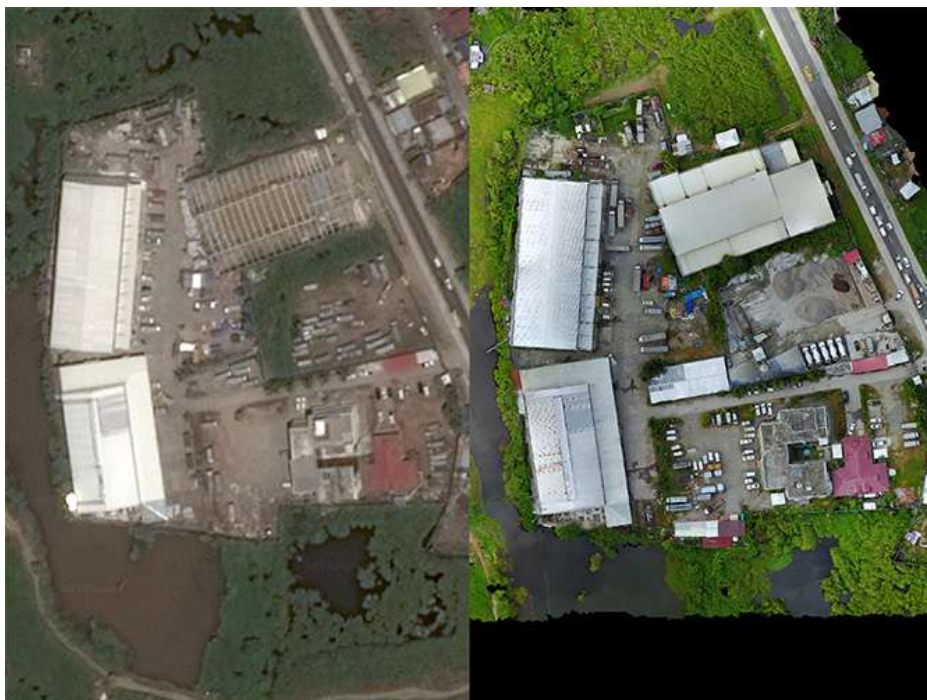
รูปที่ ๗๐ แสดงการเปรียบเทียบระหว่างภาพถ่ายดาวเทียมที่ใช้โปรแกรม google earth (ซ้าย) ภาพที่ได้จากอากาศยานไร้คนขับ (UAV) (ขวา)
