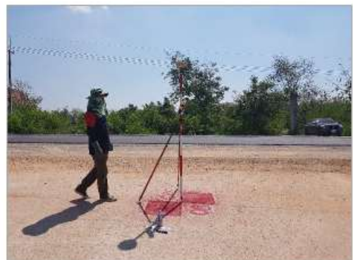
รูปที่ ๕๒ แสดงการรังวัดหมุดควบคุมภาพถ่ายและจุดตรวจสอบ
