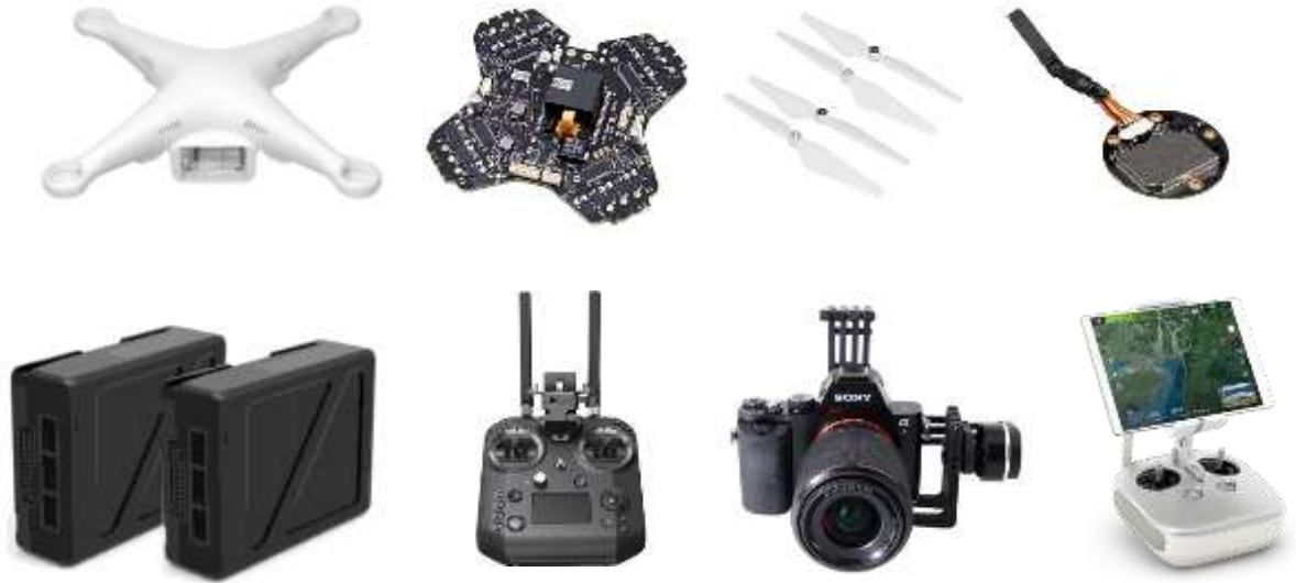
รูปที่ ๕ แสดงส่วนประกอบหลักของระบบ UAV
