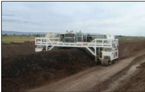
ภาพที่ 5.11 การผลิตปุ๋ยหมักแบบกองยาวบนพื้นราบ
