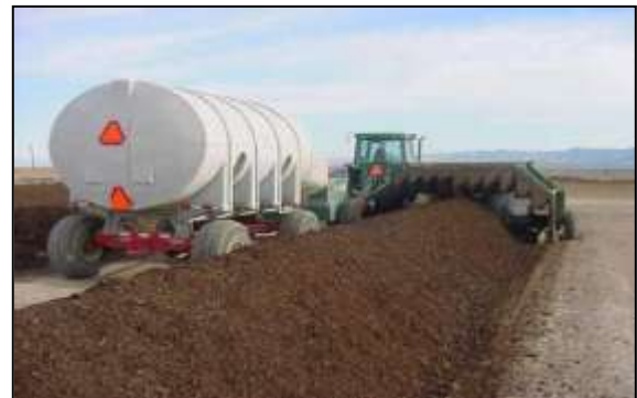
ภาพที่ 5.11 การผลิตปุ๋ยหมักแบบกองยาวบนพื้นราบ
