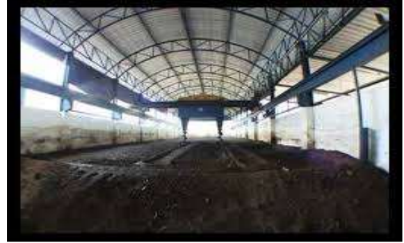
ภาพที่ 5.10 การผลิตปุ๋ยหมักแบบกองยาวใน รางซีเมนต์แบบใช้เครื่องจักร
