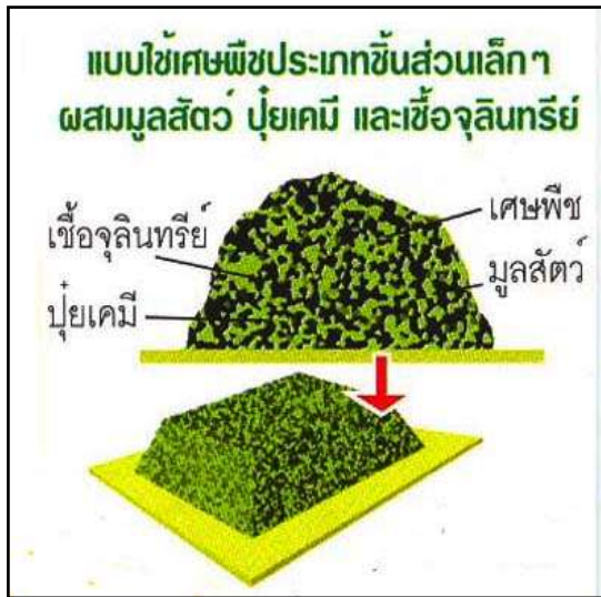
ภาพที่ 5.5 การกองปุ๋ยหมักแบบผสมคลุกเคล้า
