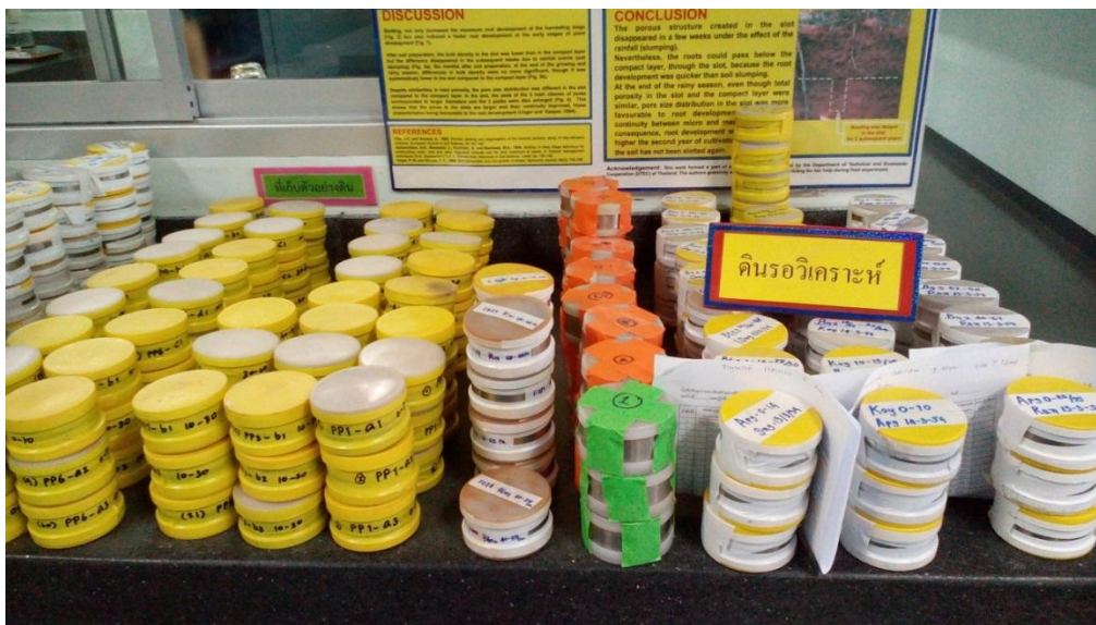
ภาพที่ 3.2 ตัวอย่างดินที่เก็บด้วยกระบอกกลม (core) แบบไม่รบกวนโครงสร้างดิน เอกสารอ้างอิง
