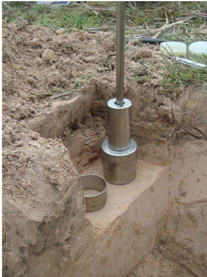
ภาพที่ 2.2 การเก็บตัวอย่างดินด้วยกระบอกกลม (core) แบบไม่รบกวนโครงสร้างดินตามชั้นกำเนิดดินภายในหน้าตัดดิน
