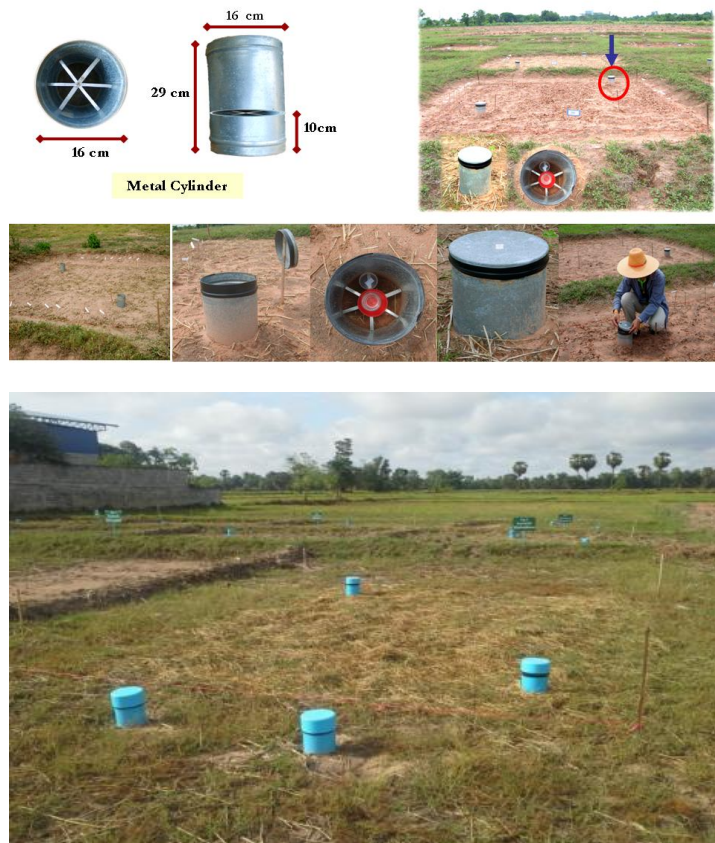
ภาพที่ 4.9 การติดตั้งอุปกรณ์สำหรับเก็บตัวอย่างก๊าซคาร์บอนไดออกไซด์ในแปลงทดลองชุดดินโคราช และชุดดินหนองบุญนา
