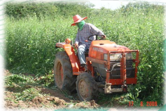
ภาพที่ ๑๕ การไถกลบพืชปุ๋ยสดในการปรับปรุงบำรุง
