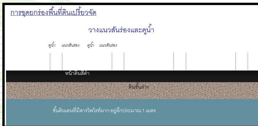
ภาพที่ ๑๗ วิธีการขุดยกร่องพื้นที่ดินเปรี้ยวโดยรักษาหน้าดินไว้
