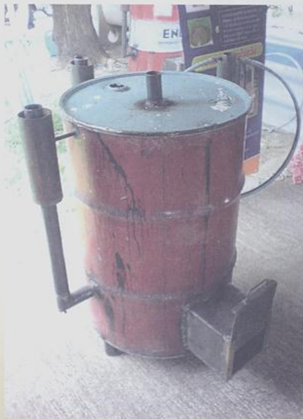
เตาเผาถ่านเคลื่อนที่มีระบบดักน้ำส้มควันไม้ กรมพัฒนาพลังงานทดแทนและอนุรักษ์พลังงาน
