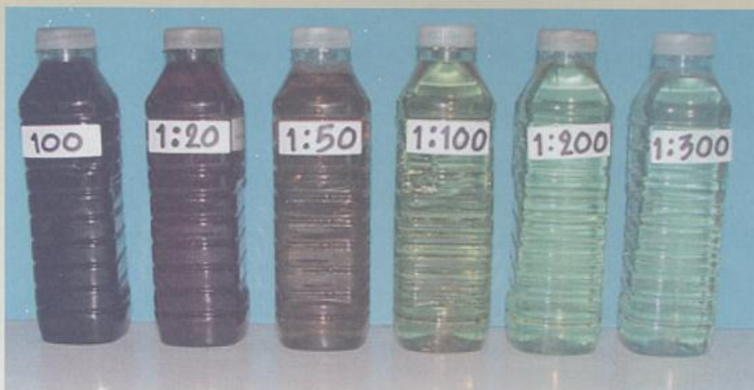
น้ำส้มควันไม้ที่มีคุณภาพดีมีค่าพีเอช (pH) อยู่ในช่วง 2.5-3.5 และมีค่าด่างจำเพาะอยู่ในช่วง 1.005 -1.015
