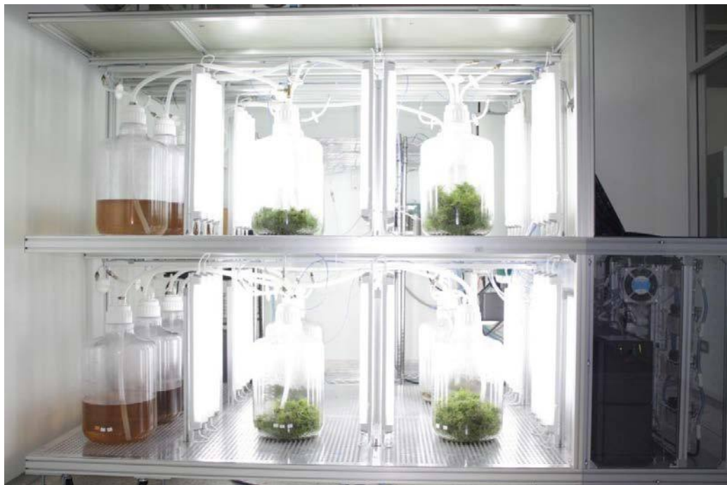
ภาพที่ 1 ระบบไบโอรีแอคเตอร์จุ่มชั่วคราวระดับอุตสาหกรรมติดตั้งที่มหาวิทยาลัยแม่โจ้
