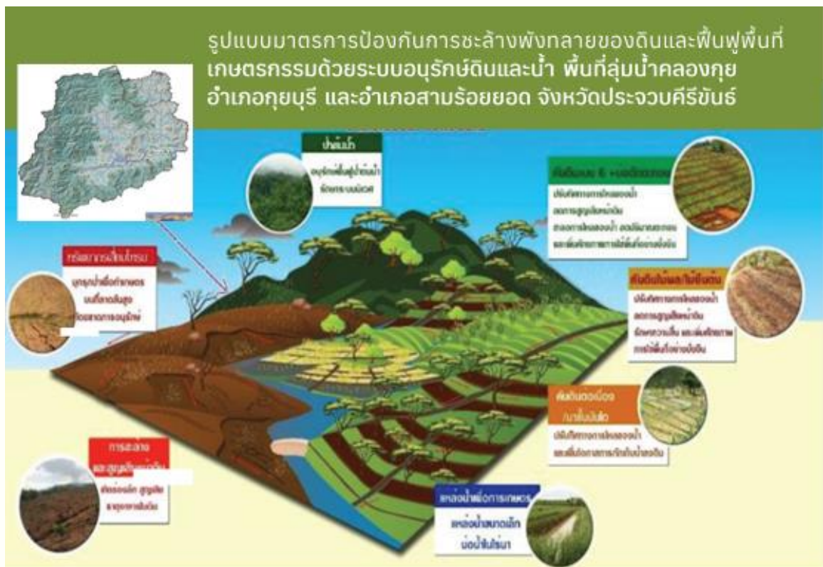
ภาพที่ 5-2 รูปแบบมาตรการเพื่อป้องกันการชะล้างพังทลายของดินและฟื้นฟูพื้นที่เกษตรกรรมด้วยระบบอนุรักษ์ดินและน้ำ ลุ่มน้ำคลองกุย อำเภอกุยบุรี และอำเภอสามร้อยยอด จังหวัดประจวบคีรีขันธ์
