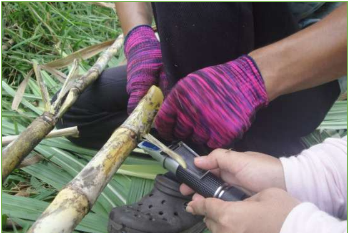
ภาพผนวกที่ 13 การวัดความหวานของอ้อยด้วยเครื่องมือ refractometer
