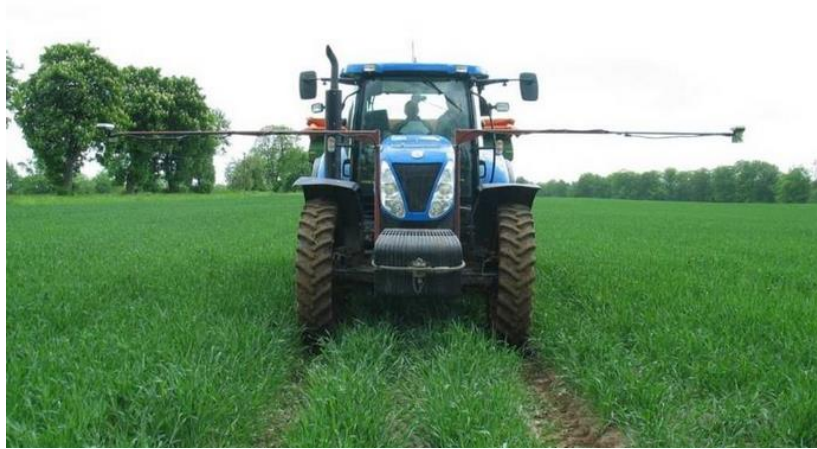
ภาพที่ 3 การจัดเก็บข้อมูลระดับพื้นดินโดยใช้เซ็นเซอร์ติดกับพาดหระ ที่มา : Piekutowska et. al. (2018)
