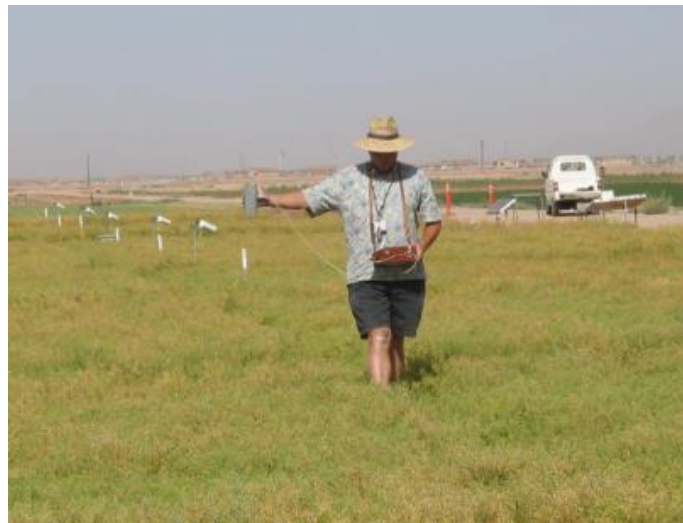
ภาพที่ 2 การจัดเก็บข้อมูลระดับพื้นดินโดยใช้เครื่องวัดดินเซ็นเซอร์แบบแบบมือถือ ที่มา : Clarke (n.d.)
