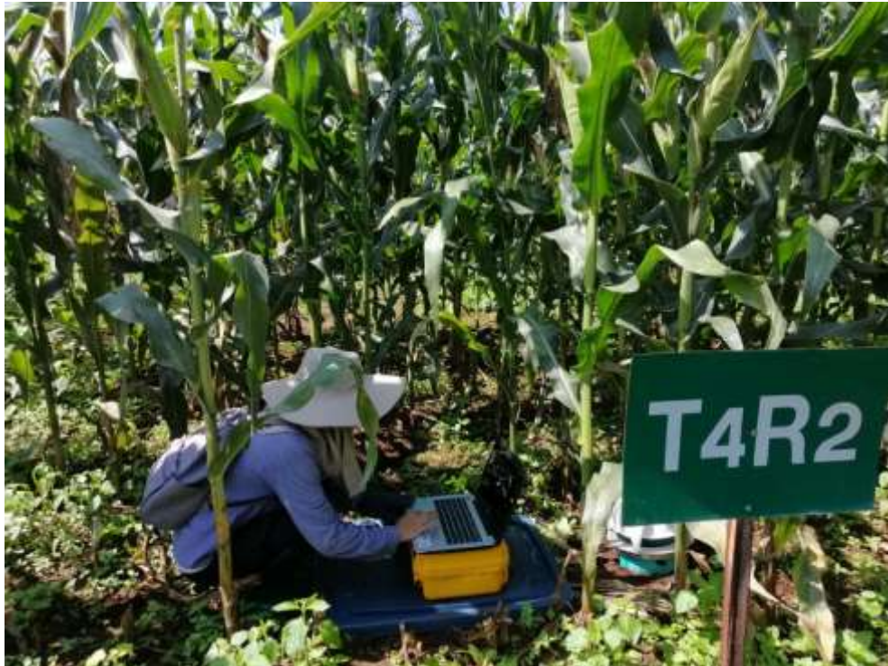
ภาพภาคผนวกที่ 34 การวัดอัตราการหายใจของดิน
