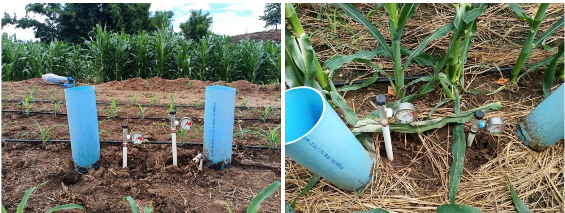
ภาพภาคผนวกที่ 5 การติดตั้งเครื่องวัดความชื้นในดิน (tensiometer)
