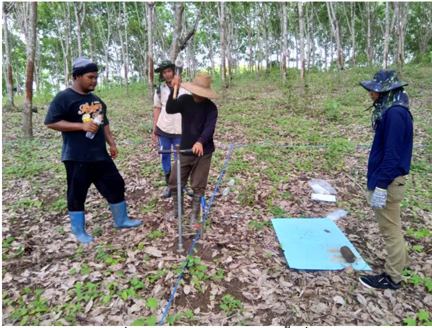
ภาพผนวกที่ 14 การเก็บตัวอย่างดินในพื้นที่ป่ายางพารา
