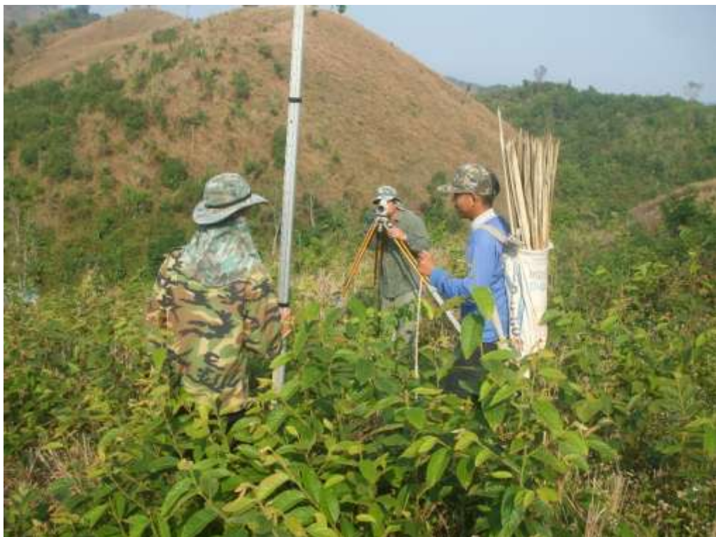
ภาพภาคผนวกที่ 4 การทำแนวระดับ โดยใช้กล้องส่องระดับ ระยะห่างในแนวตั้ง (VI = 6 เมตร)
