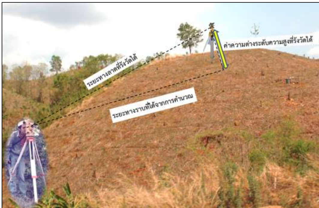
ภาพที่ ๒-๒ การหาค่าความลาดชันของพื้นที่โดยวิธีการสำรวจรังวัดในภูมิประเทศ
