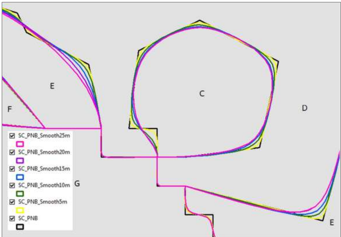
ภาพที่ ๒-๖ ผลลัพธ์ของเส้นขอบเขตของรูปปิดที่เกิดขึ้นจากการกำหนดระยะทางของการย้ายส่วนที่ใช้จำนวนจุดใหม่ (Smoothing tolerance) เท่ากับ ๕ เมตร ๑๐ เมตร ๑๕ เมตร ๒๐ เมตร และ ๒๕ เมตร
