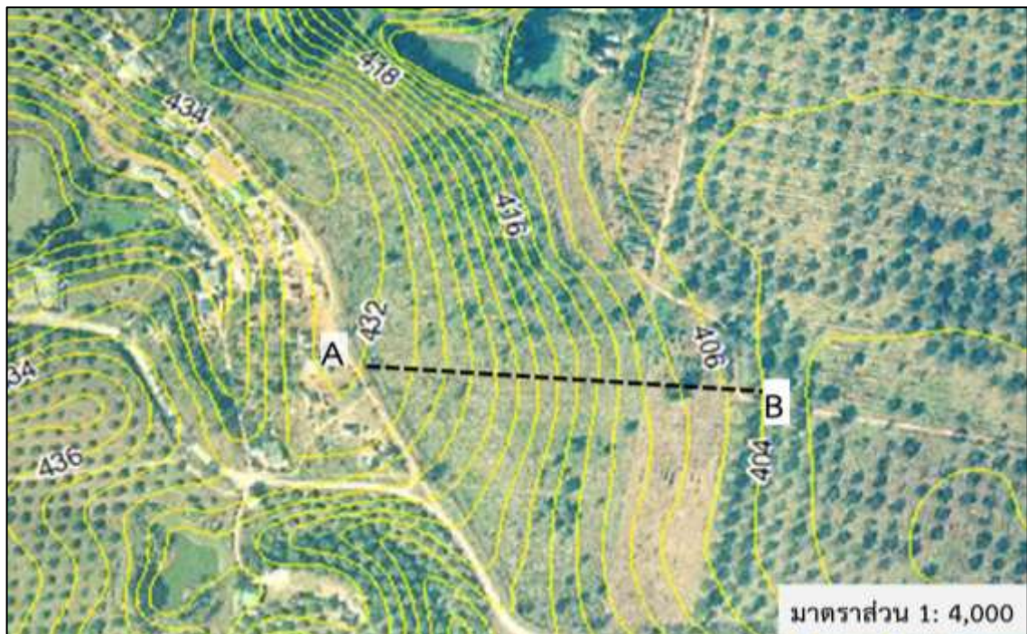
ภาพที่ ๒-๓ การคำนวณค่าความลาดชันของพื้นที่โดยวิธีการรังวัดจากแผนที่และเส้นชั้นความสูง
