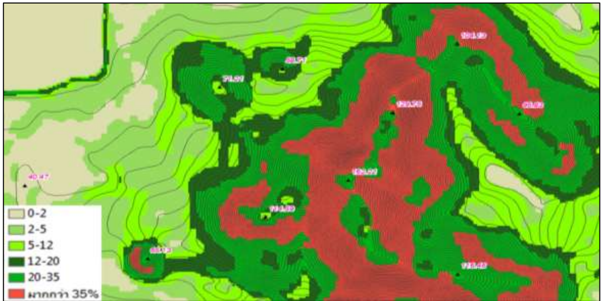
ภาพที่ ๒-๕ การหาค่าความลาดชันของพื้นที่โดยการวิเคราะห์ความลาดชันจากข้อมูลความสูงภูมิประเทศ ด้วยโปรแกรมสารสนเทศภูมิศาสตร์
