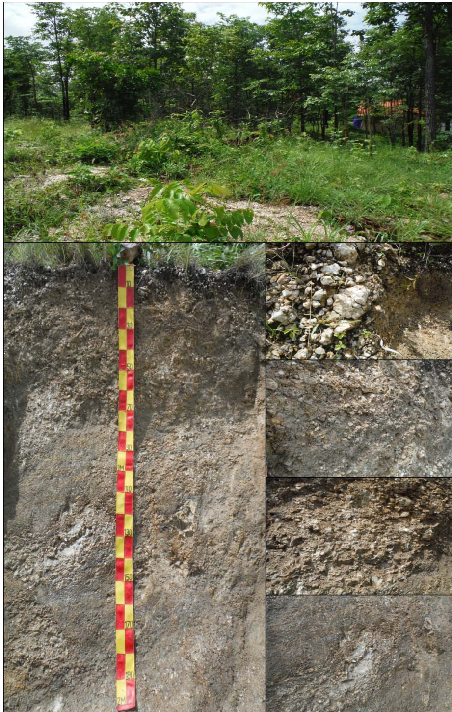
ภาพที่ 5-2 ลักษณะภูมิประเทศและหน้าตัดดินของชุดดินทับเสลา
