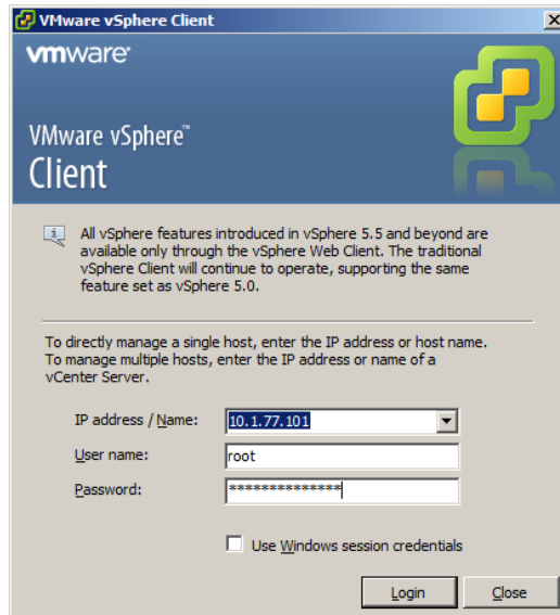
ภาพที่ ๔ - ๑ การระบุไอพีแอดเดรส ชื่อผู้ใช้ และรหัสผ่าน เพื่อเชื่อมต่อเครื่องแม่ข่าย ESXi
