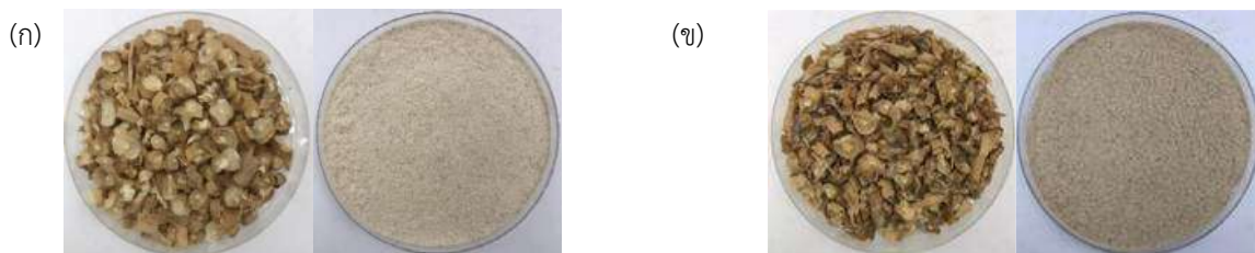
ภาพที่ 3.26 แสดง (ก) ตัวอย่างรากสามสิบอบแห้งที่ไม่ผ่านการลวกก่อนอบแห้งด้วยเครื่องอบไมโครเวฟแบบลมร้อนที่ 60°C 1000 วัตต์ และ (ข) ตัวอย่างรากสามสิบอบแห้งที่ผ่านการลวกก่อนอบแห้งที่ 60°C 1000 วัตต์ ทั้งก่อนบดและหลังบด
