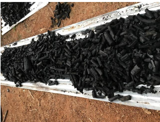
ภาพภาคผนวกที่ 4 ถ่านชีวภาพที่ได้จากการเผาไม้ยูคาลิปตัสและบดให้เล็กลงสำหรับการทดลอง
