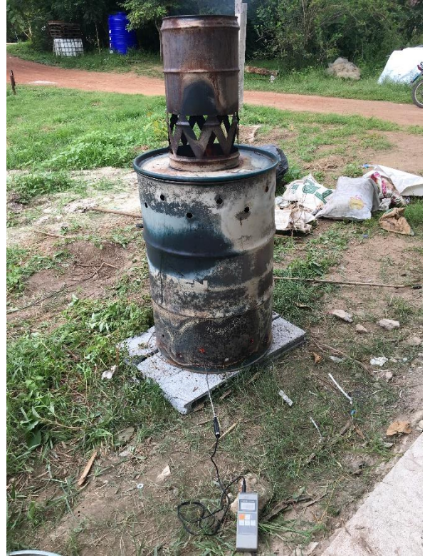
ภาพภาคผนวกที่ 3 การเผาถ่านชีวภาพจากเตาเผาถ่านชีวภาพถัง 200 ลิตร
