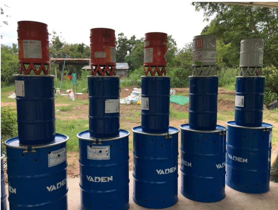
ภาพภาคผนวกที่ 2 การผลิตเตาเผาถ่านชีวภาพจากถัง 200 ลิตร
