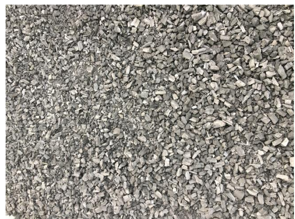
ภาพภาคผนวกที่ 4 ถ่านชีวภาพที่ได้จากการเผาไม้ยูคาลิปตัสและบดให้เล็กลงสำหรับการทดลอง
