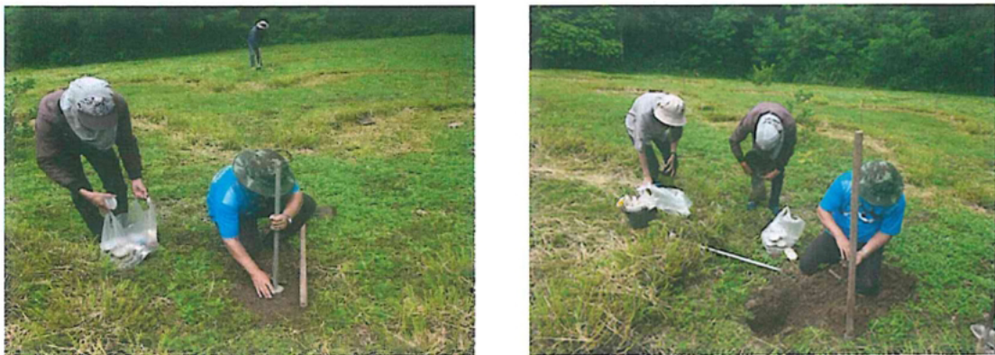
ภาพที่ 3.5 การเก็บตัวอย่างดินแบบไม่รบกวนโครงสร้างดินในพื้นที่จังหวัดเชียงใหม่
