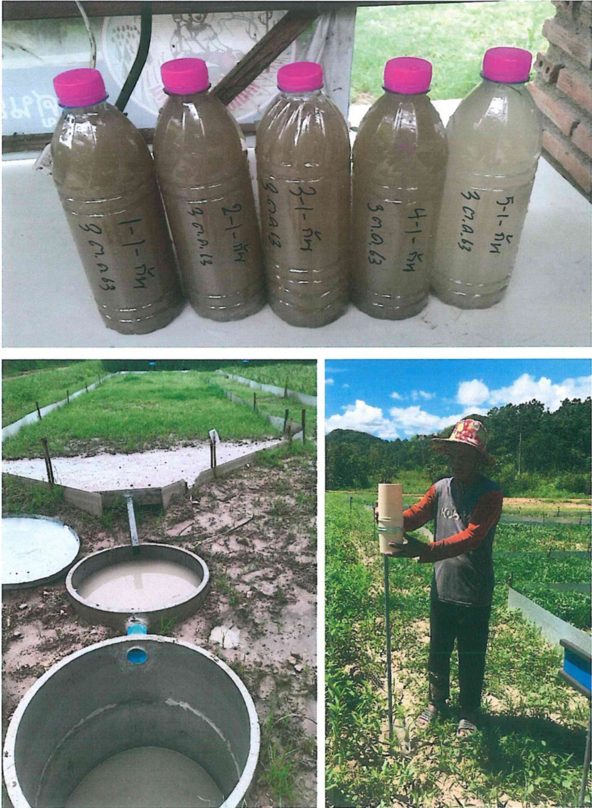
ภาพที่ 3.13 การเก็บตัวอย่างน้ำและตะกอน และข้อมูลในแปลงทดสอบในพื้นที่จังหวัดประจวบคีรีขันธ์
