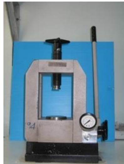
ภาพที่ 5 เครื่องอัดดิน Spex hydraulic press
