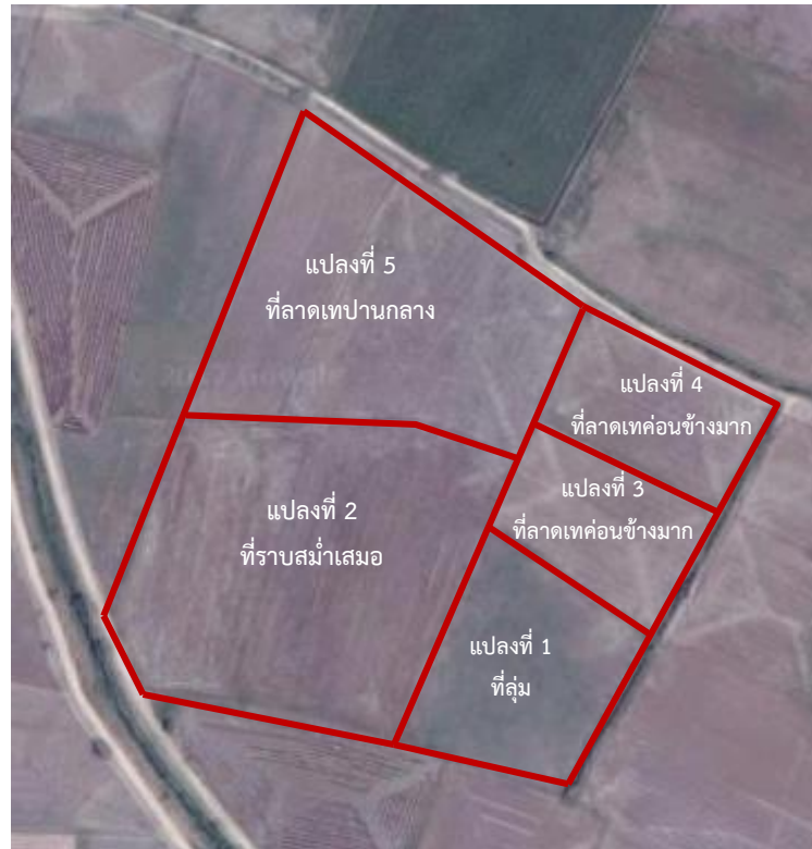
ภาพที่ 2 การแบ่งแปลงเก็บตัวอย่างดินตามลักษณะความแตกต่างของพื้นที่
